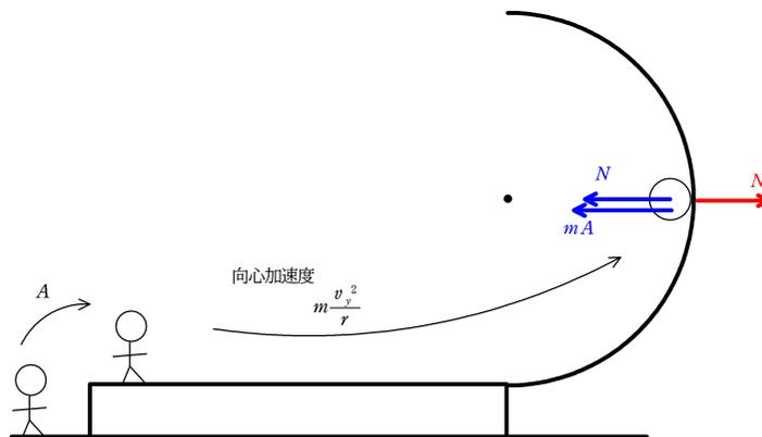
また、垂直抗力の大きさを  $N$ 、床で静止した人からみた台の水平加速度を  $A$  として、台からみた物体の向心方向の運動方程式と床からみた台の水平方向の運動方程式を立てる。台からみた物体の向心方向の運動方程式を立てる際、慣性力を忘れないように注意する。
