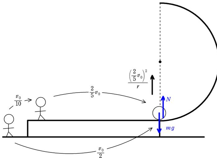
垂直抗力の大きさを  $N$  として, 台からみた物体の向心方向の運動方程式を立てる.
